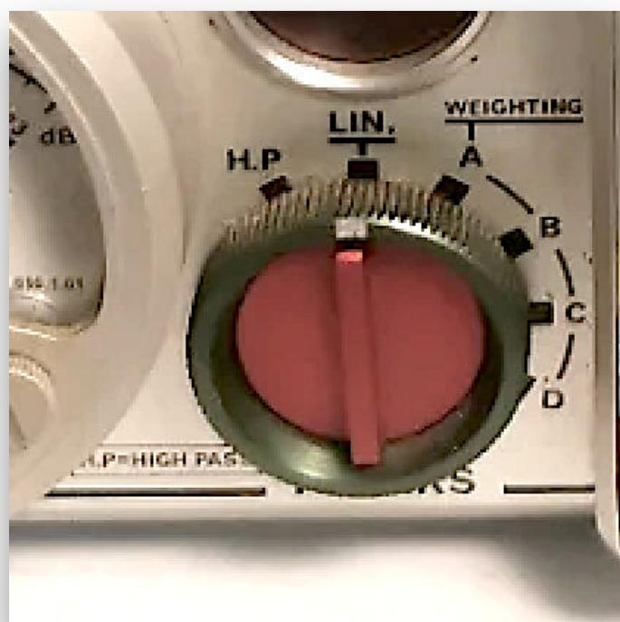
Nu is het zo dat voor High Fidelity (muziek, zang, stemmen) de Nagra's 4-2 & 4-S vlak (lineair) opnemen maar deze Nagra-SJ heeft specifieke aanpassing voor exacte meting toepassingen en aardig is dan weer dat een gedeelte van wat de mens gewoon ook horen kan, met de dB(A) filter setting in de opname niet meer aanwezig is, die A weighting filter setting overeenkomstig als de potlood streep te zien is in de bij ons op 31 januari 2019 gemaakte metingen.
